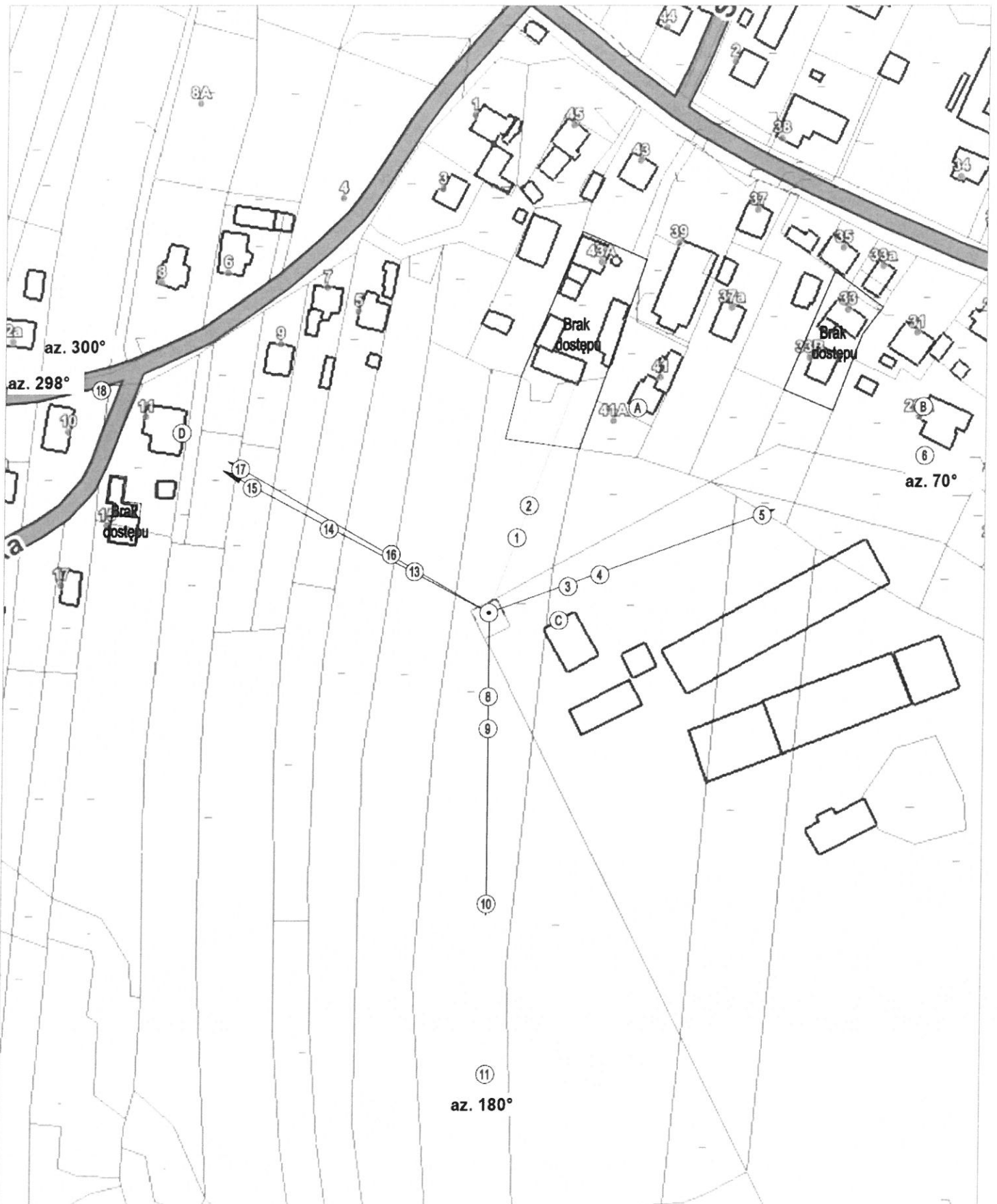
Rysunek 4 - Rozmieszczenie pionów pomiarowych wzdłuż ulicy w celu pomiaru natężenia pola EM
